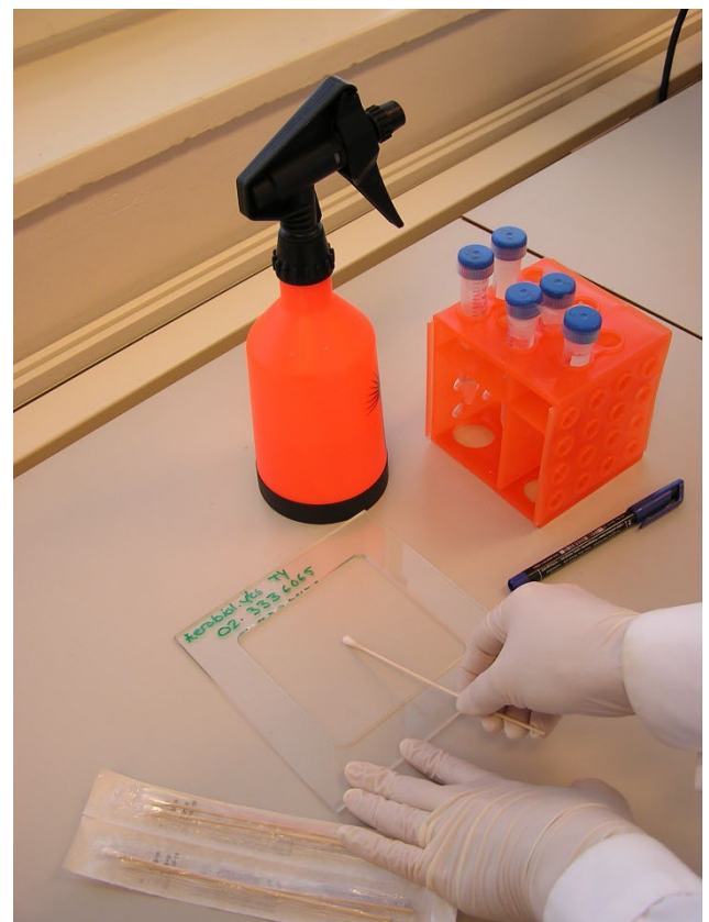
Kuva 2. Tutkittava pinta sivellään kolmeen kertaan mittakehystä käyttäen.
