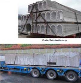
Kantengleiter müssen verwendet werden, wenn Betonelemente mit Zurrgurten gesichert werden.
