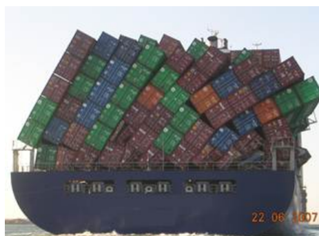
Fotos von verrutschter Ladung auf einem Containerschiff
