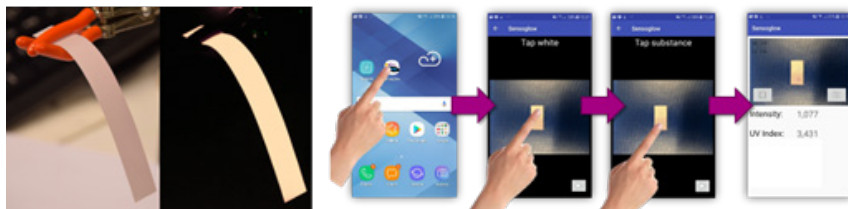
Kuva 5. Taipuisa, pimeässä valkoisena loistava SensoGlow®-materiaali (vas.) ja SensoGlow®-applikaation toimintaperiaate (oik.).
