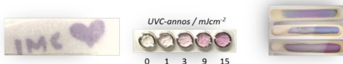
Kuva 4. Fotokromismilla kuvitettu pinta, fotokromisen materiaalin värin voimakkuus eri UVC-säteilyannosten vaikutuksesta ja eriväristä fotokromismia.
