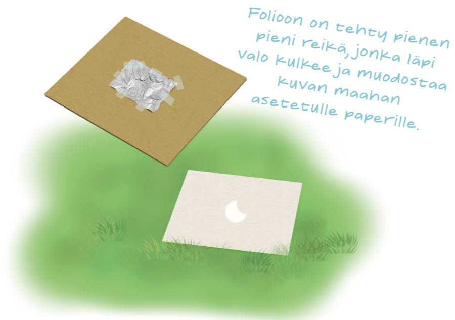
Piirroskuva neulanreikäkameran käytöstä. Kuva: Sanna Launiainen
