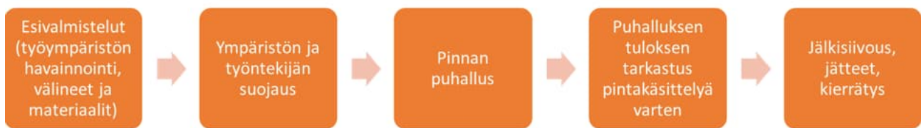
Kuva 1. Hiekka- ja raepuhallusprosessin vaiheet.
