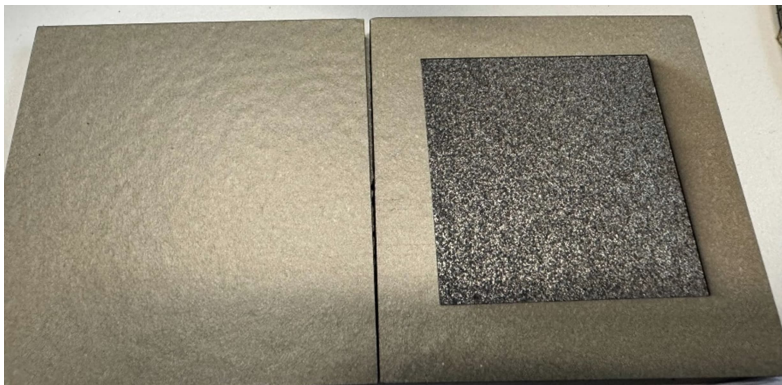
Kuva 8. Maalattu metallilevy ennen (vas.) ja jälkeen (oik.) laserpuhdistuksen.
