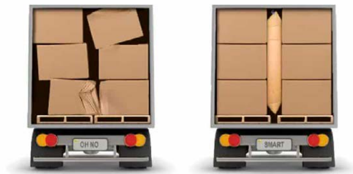
Kuva 41. Kevyen lastin tuenta tuentasäkillä: vasemmalla tukematon kuorma, oikealla tuentasäkillä tuettu kuorma
