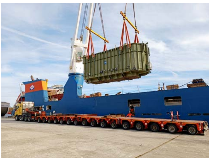
Kuva 17. 3+4+5 -akselinen moduulilavetti. Kuva: Kuljetusliike Ville Silvasti Oy
