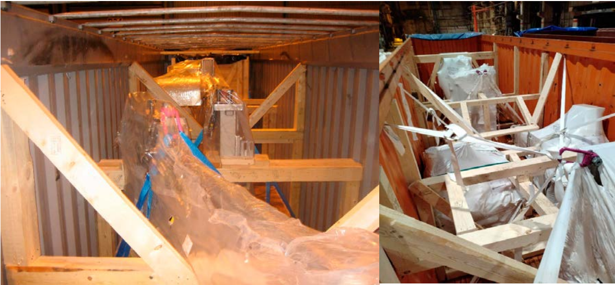
Kuva 64. Esimerkkikuvia tukemisesta lastinkuljetusyksikköön Kuva : Valmet Technologies Oy
