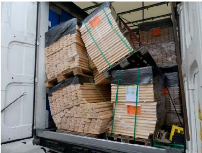
Kuva 30. Puutteellisesti sidottu ja tuettu puutavarakuorma lastinkuljetusyksikössä
