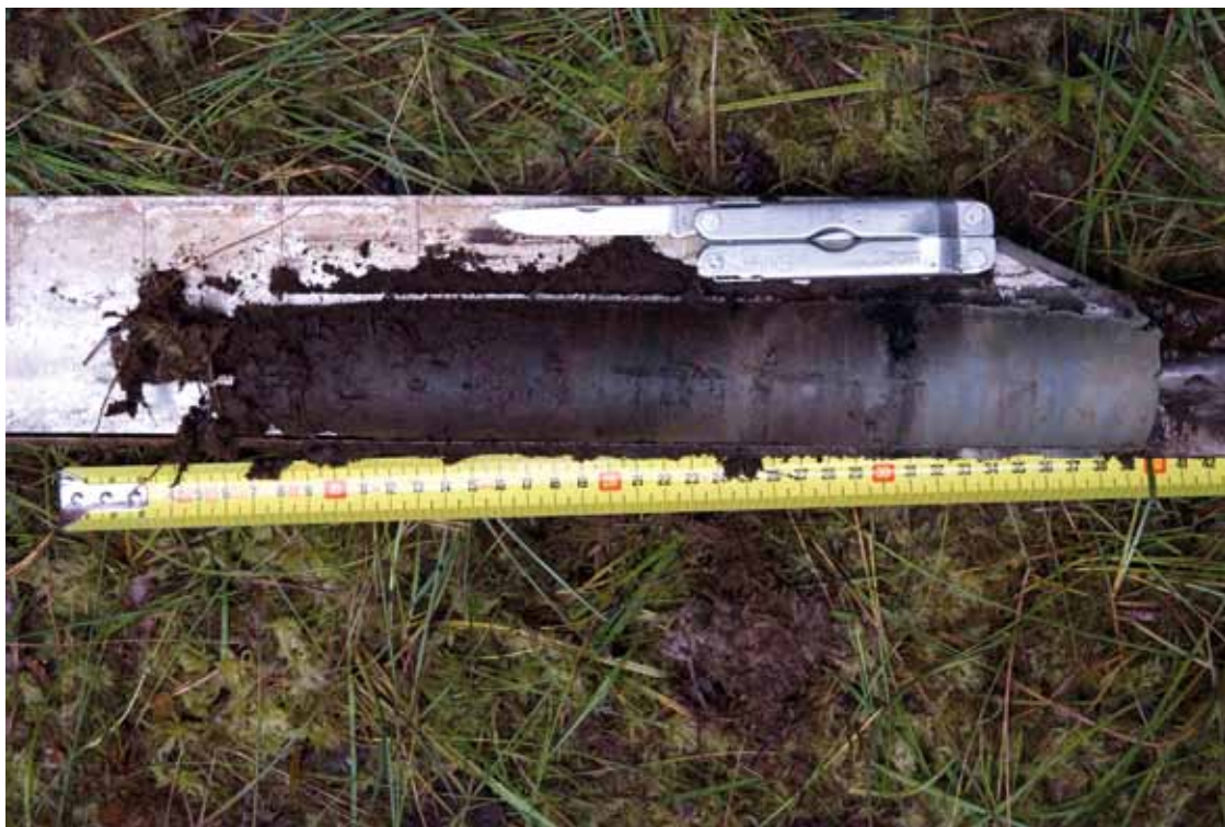
4. Seilin Saukkosuon maankohoamista havainnollistava maaperän kerrosjärjestys tutkittuna suokairalla. Alimpana kerroksena näytteessä meren pohjalle kerrostunut savi (vaaleampi osa oikealla), keskellä (mitassa 25 cm kohdalla) matalan veden rantahiekkakerros ja ylimpänä rantavyöhykkeen yläpuolelle syntynyt tumma, osin hyvin maatunut rahkaturve. Kuva: Ilkka Salminen 2007
