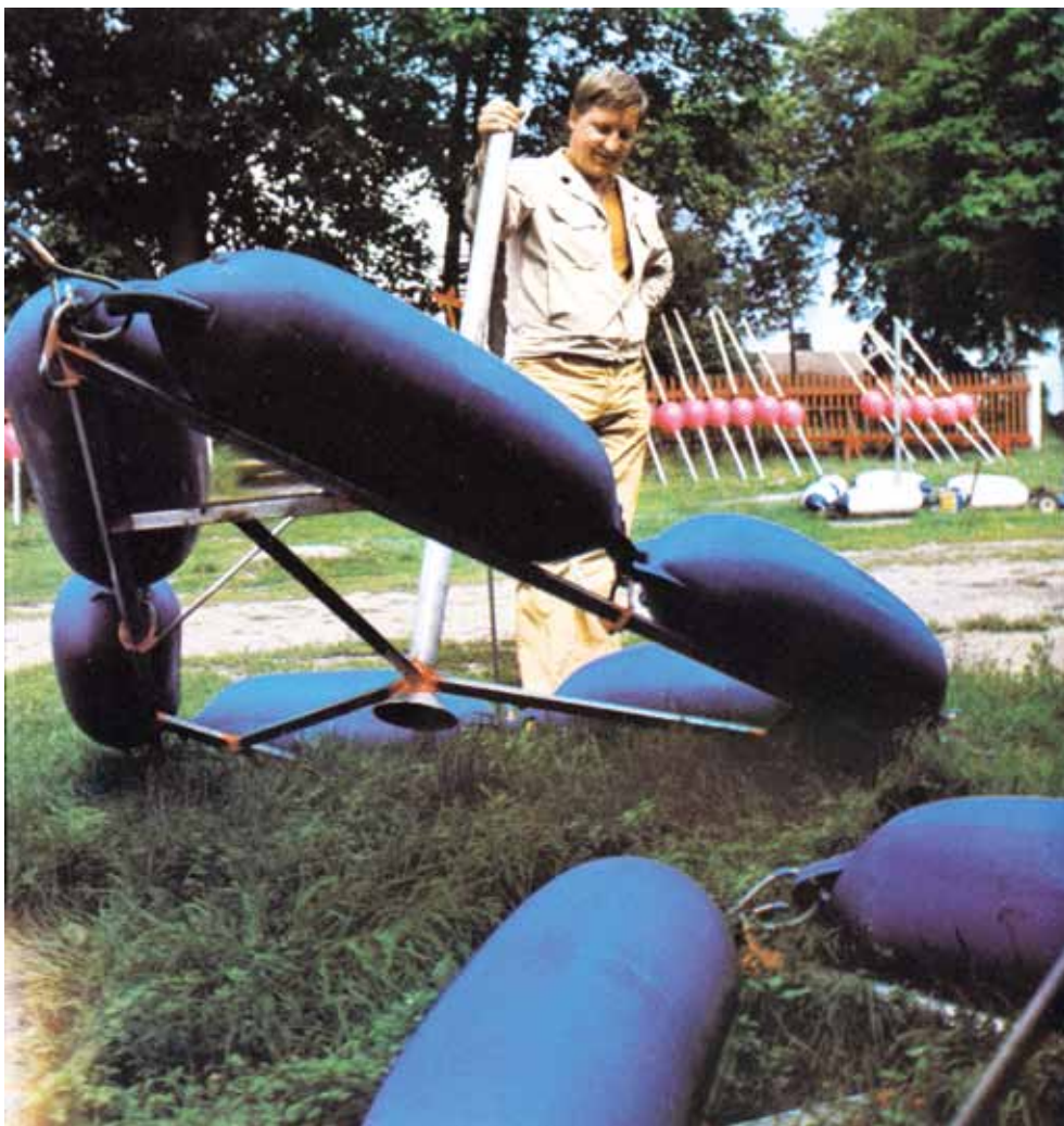
Myös virtausmittareiden ripustimet tehtiin laitoksen työpajassa itse. Kuvassa asemanhoitaja Tapani Juusti tutkii juuri valmistunutta telinettä. Kuva: Öljyposti 3 1974.
