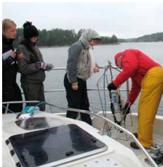
B) Vesipatsaan lämpötilan, sähkönjohtokyvyn ja happipitoisuuden mittausta CTD-sondilla, jonka käytössä opiskelijoita opastaa Ilppo Vuorinen.
