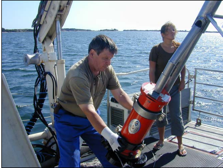
Kuva 1. ADCP-virtausmittari. (Valokuva: Tuula Kohonen 2003).
