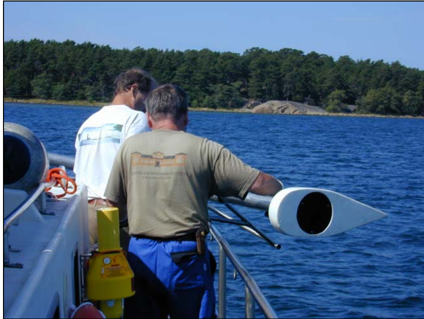
Kuva 3. Kaikuluotaimen anturi. (Valokuva: Tuula Kohonen 2004).
