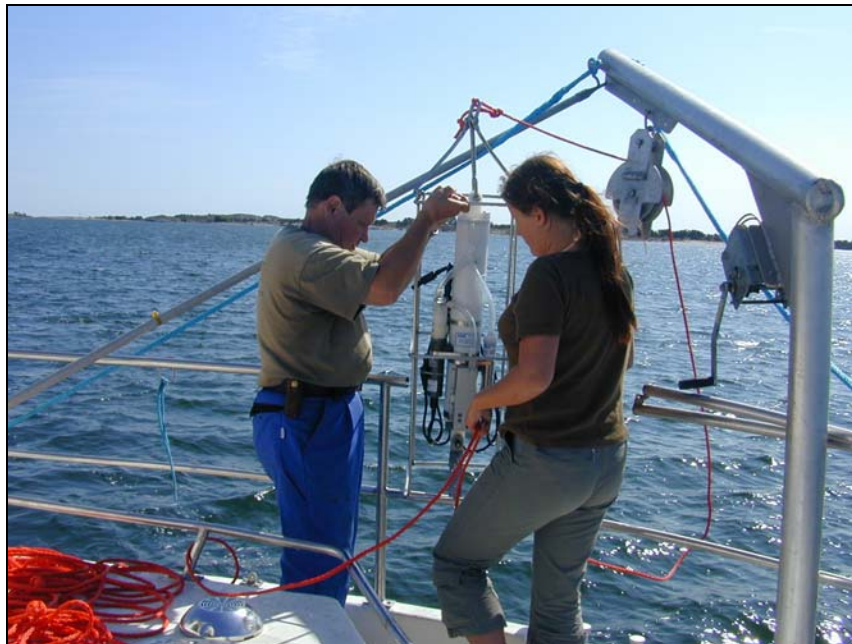
Kuva 2. CTD-sondia lasketaan mereen. (Valokuva: Tuula Kohonen 2003).
